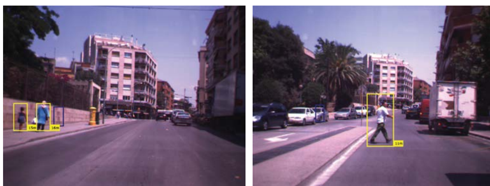
Deteccions finals del sistema. En groc les deteccions correctes amb la distància estimada del vianant a la càmera. En blau les deteccions incorrectes (falsos positius).
